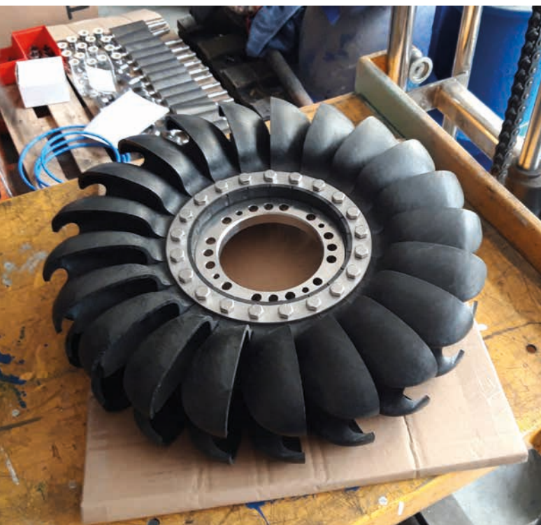
↑ Montáž generátoru s oběžným kolem ↓ Detail oběžného kola Peltonovy turbíny s lopatkami
