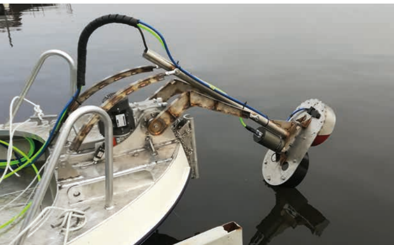
← Měřící echoloty umístěné na výklonném rameni na přídi lodi
