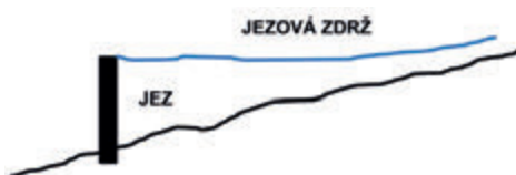
Zjednodušené schéma jezu
