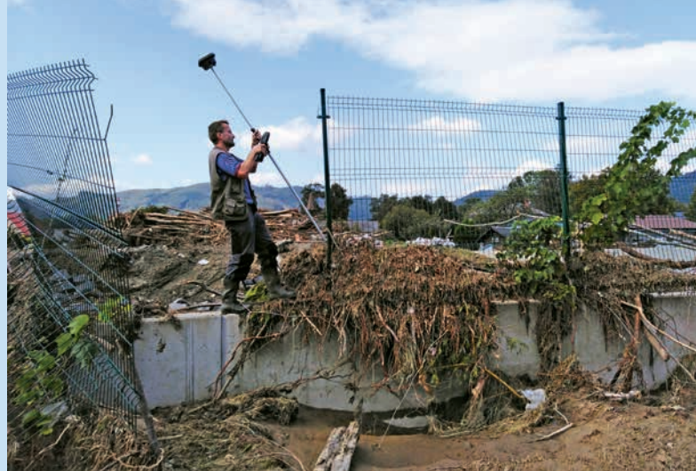
Nános naplavenin řeky Desné v Rapotíně značí, kam až voda nastoupala ↑ Zaměření maximální hladiny pod železniční vlečkou u Vitošova ↓
