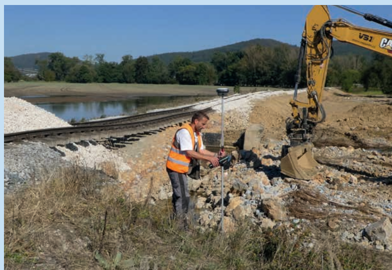
Nános naplavenin řeky Desné v Rapotíně značí, kam až voda nastoupala ↑ Zaměření maximální hladiny pod železniční vlečkou u Vitošova ↓
